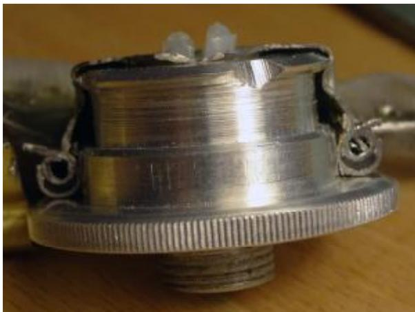
Anpassung des Adapters an die Bajonett-Noppen im Easyclick Anschluss anhand einer entleerten und aufgesägten Kartusche.
